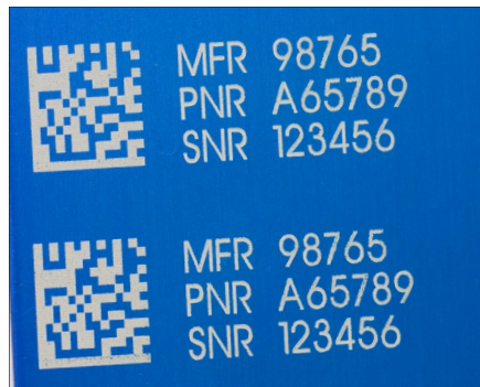
塗装された金属への二次元コードマーキング
